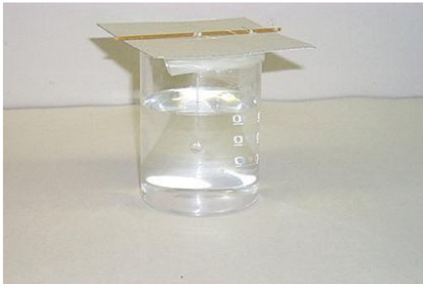
Figura 3. Semilla de alumbre suspendida en una solución saturada. (Foto de Luc Van Meervel)
